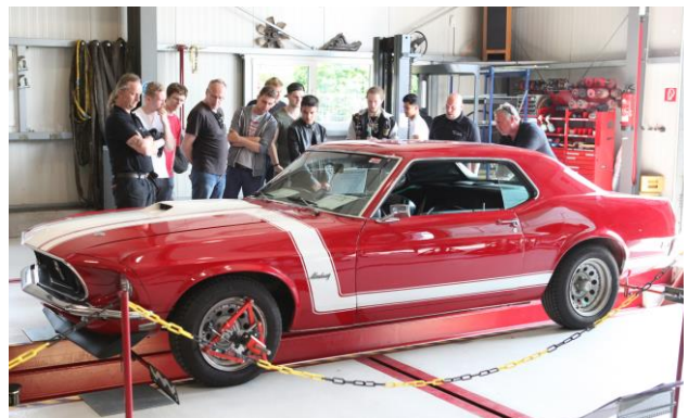
Achsvermessung am Ford Mustang
